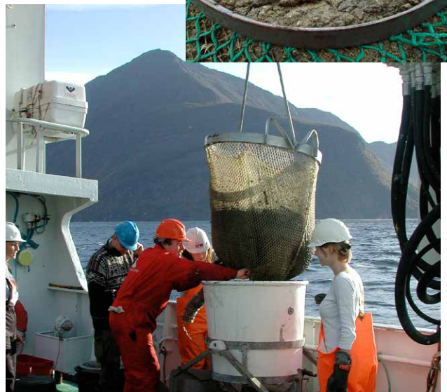
Ringskrapa (rs) – öppning 70 cm, maskvidd: 20 mm. Foto Tomas Cedhagen.
