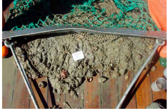
Bergskrapa (bsk) – öppning 80 x 20 cm, maskvidd 15 mm.
