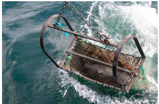
Agassizslåde (az) – öppning 80 x 50 cm, maskvidd: 20 mm.
