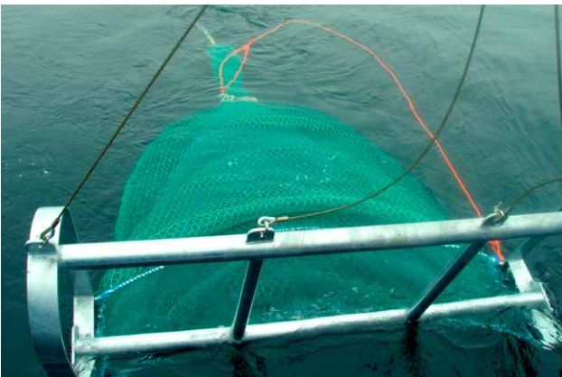
Agassizslåde (az3) - öppning 250 x 70 cm, maskvidd (på den inre delen; cod end): 15 mm.
