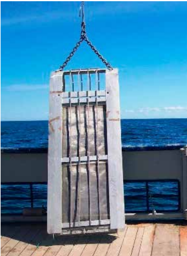
Warénsläde (ws) – öppning 60 x 15 cm, maskvidd: 0,5 mm.
