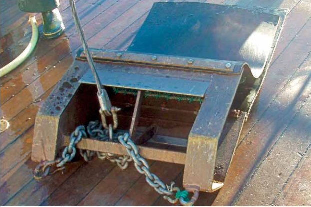
Bergskrapa (bskh) – öppning 40 x 20 cm, maskvidd 10 mm.
